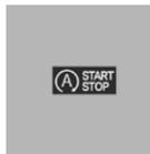
Индикатор сигнализирует, что система автоматического запуска/останова двигателя готова к автоматическому пуску двигателя.
