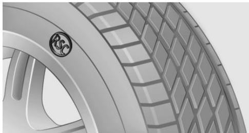
Маркировка шин, допускающих движение в аварийном режиме, на боковой стенке шины. Колеса состоят из самонесущей шины и специального диска.
