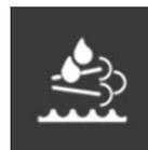
При появлении индикатора -- двигатель продолжает работать до его выключения и при условии соблюдения всех других требований для дальнейшей эксплуатации, например, достаточного количества топлива.
