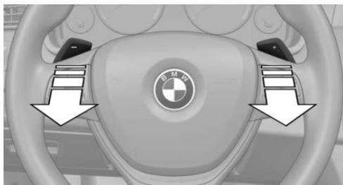
Переключатели на рулевом колесе позволяют осуществлять быстрое переключение передач, поскольку обе руки остаются на рулевом колесе.
