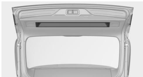
На внутренней обшивке крышки багажника имеется ручка, которая облегчает вытягивание.
