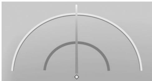
Расстояние прицепа до тягово-сцепного устройства можно определить с помощью двух статических полуокружностей.
