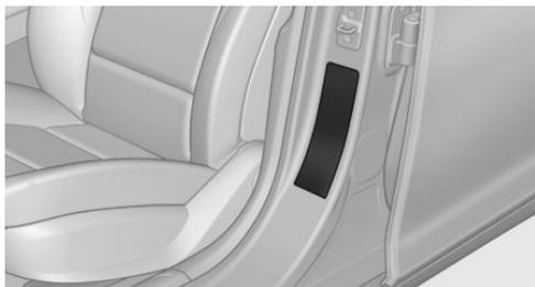
Нормы давления для рекомендованных размеров шин указаны на стойке двери водителя.
