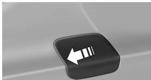
2. Поверните пробку топливного бака против часовой стрелки.
